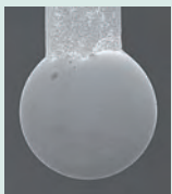
UMAP 107 ø70 µm L = 5 mm
