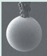
UMAP 103 ø30 µm L = 2 mm
