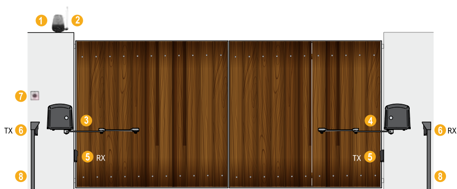
1_Lámpara de señalización 2_Antena exterior 3_Cuadro de maniobra 4_Selector de llave 5_Fotocélula exterior 6_Fotocélula interior 7_Motores 8_Apoyo fijo para fotocélulas
