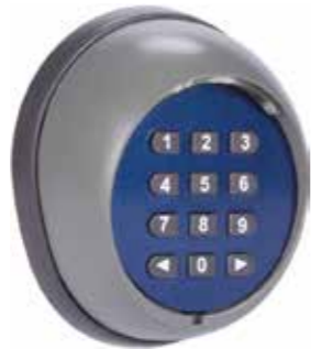
TECLADO NUMÉRICO 868 MHZ , sem fios, com alcance de 100m em espaço aberto e 35m no interior do edifício. 55 x 63 x 16 mm / IP54
