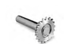
CRA1 Arbre avec engrenage 18 dents Ø arbre 25,4 mm Ø int. pignon 25,4 mm. Unités/Cond. 1
