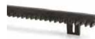
ROA66 Crémaillère M4 25x20x1000 mm perforée en nylon à noyau métallique six points de fixation. Pour portails d'un poids max. de 800 kg. Unités/Cond. 10
